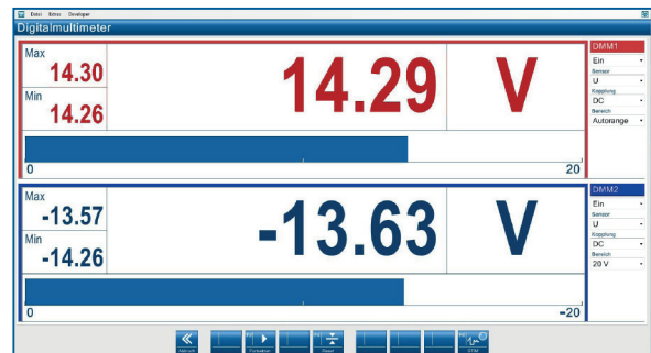
Display multimetro: la tensione della batteria e della sonda lambda.
